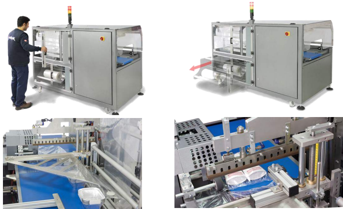
Bande d'alimentation et conformateur à hauteur réglable
