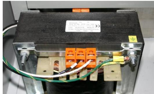
Transformateur soudure 400V Sec 75V
